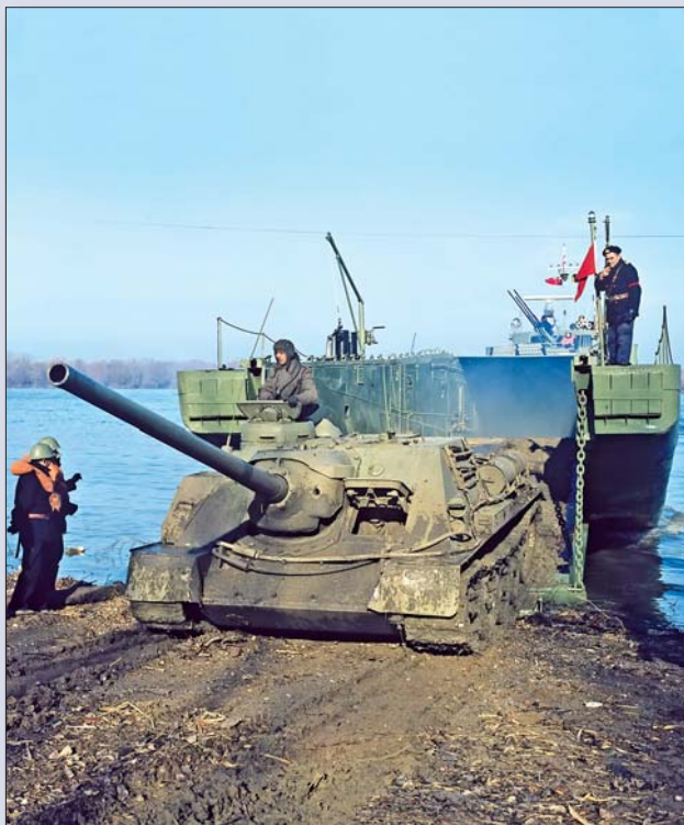
Искрцавање самоходног оруђа СУ-100 из тенконосца на вежби „Челик 78“ децембра 1978. код Удовице. Код командног моста виде се шуреле, које су већ уграђене, али још увек нису добиле аутоматске бацаче граната
