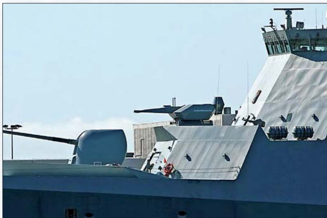
Дејлаљ брод са шпоом Mk45 Mod4 калибра 127 mm и Oerlikon Millennium од 35 mm за блиску вироивракејну одбрану
