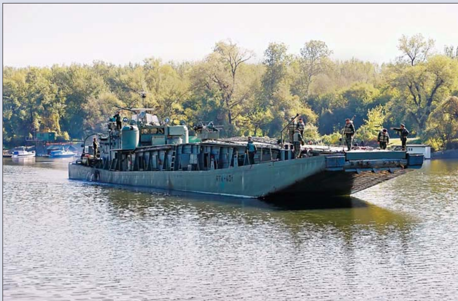
РТК-401 пред крај каријере у 21. веку – на централном делу брода видљив је четвороцевни ПАТ, вишецевни лансер ракета „пламен“ на позицији иза ПАТ-а и две шуреле са бацачима граната поред командног моста
